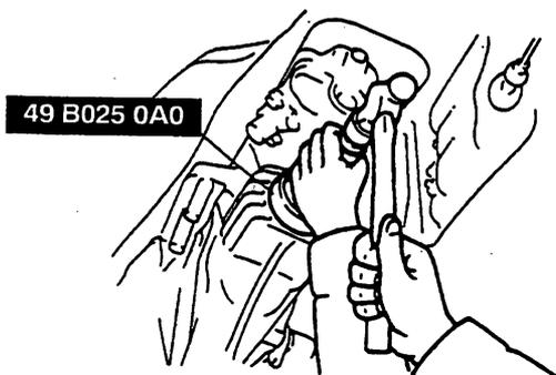
6. プロペラシャフトを取付ける。(参照：セクション L、プロペラシャフト、プロペラシャフト取外し/取付け)
